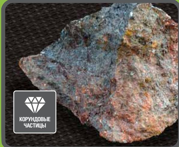
Покрытие SVEZA Titan содержит корундовые частицы, которые обеспечивают исключительные противоскользящие свойства и износостойкость.
