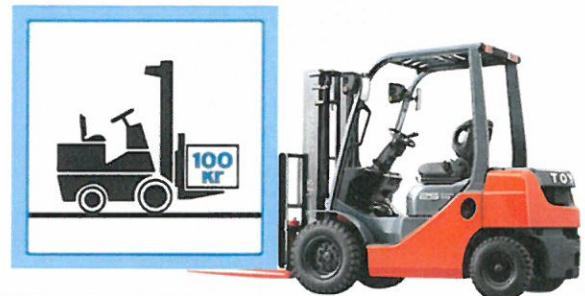
6.26. Вести нагруженный погрузчик при спуске под уклон более 3° следует только на заднем ходу и с малой скоростью.
